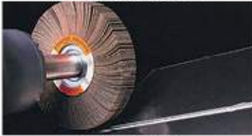
Flap Wheels zımparalar, Kaynak yüzeyi temizleme ve çapak alma.
