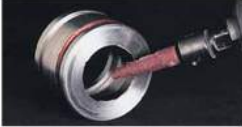
Cartridge burmalı zımparalar, Köşe temizleme ve çapak alma.
