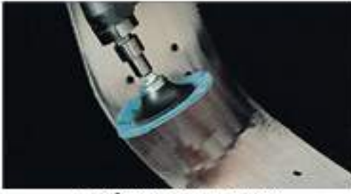
SocAtt® çabuk deęiřtirme diskleri, Yüzey temizleme ve çapak alma.
