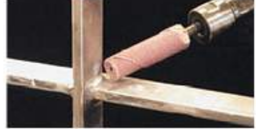
Cartridge burmalı zımparalar, Paslanmaz çelik yüzey temizleme ve çapak alma.
